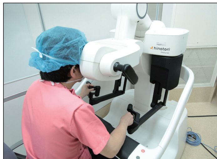
術者がコックピットでロボットアームを操作。 ロボットアームの関節も多くあるため、術者の微細な動きを反映することが可能。
